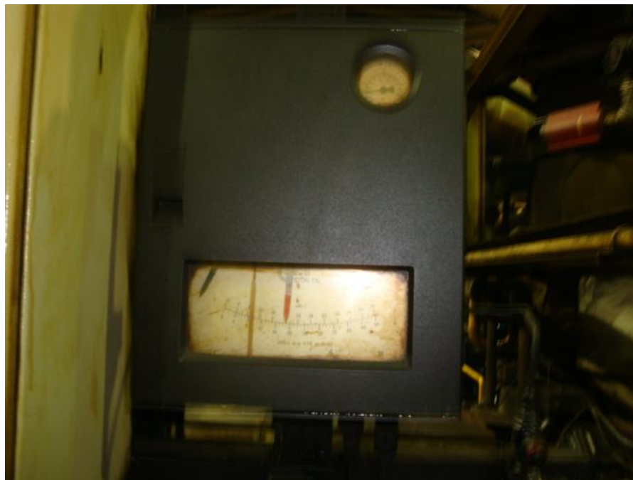
Figura 2.18 Viscosímetro analógico deteriorado, no se puede medir viscosidad
