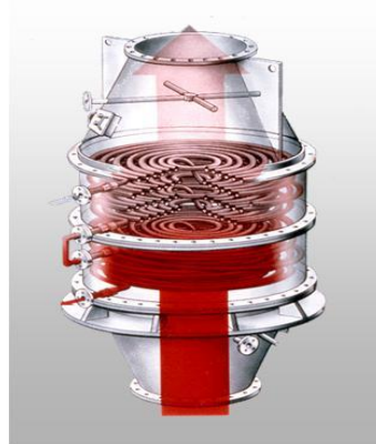
Figura 2.11 Esquema de funcionamiento del intercambiador de calor.
