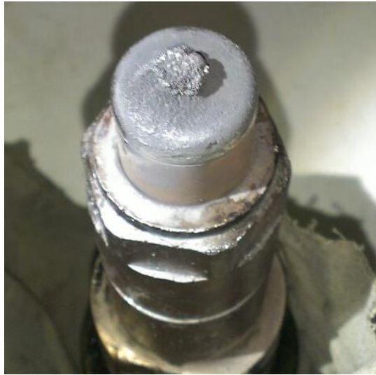
Figura 1.10 Obstrucción de toberas debido a la mala combustión por alta viscosidad.
