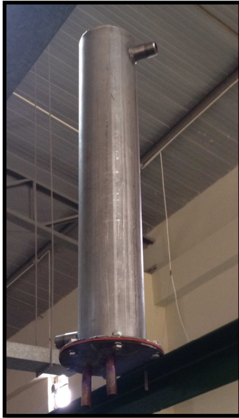
Figura 5.3. Condensador Ubicado en Unidad de Destilación
