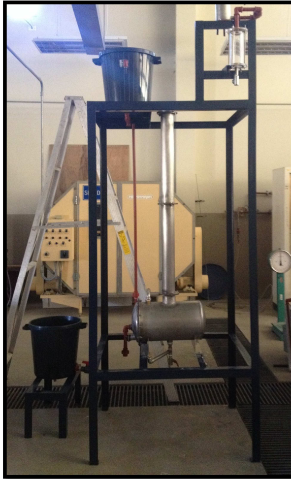
Figura 5.4. Estructura de Soporte para Unidad de Destilación
