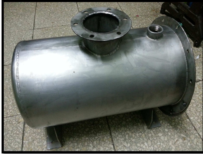
Figura 5.2. Calentador Empleado en Unidad de Destilación
