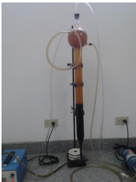
Figura 4.5.- Reactor UASB en funcionamiento. Fuente: Alcívar 2014
