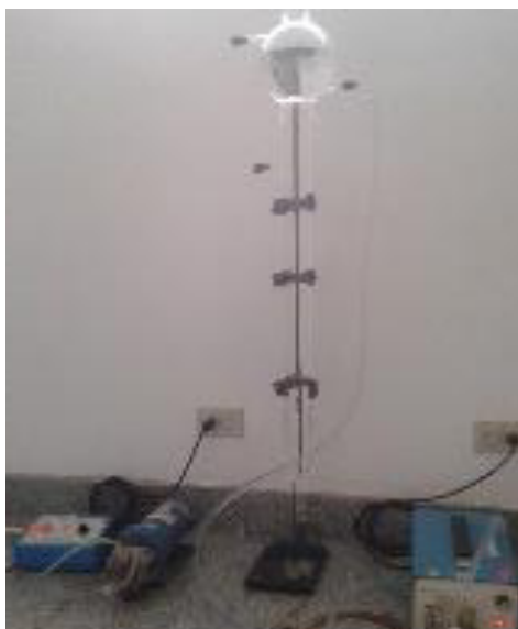
Figura 4.4.-Pruebas hidrostáticas del reactor UASB. Fuente: Alcívar 2014
