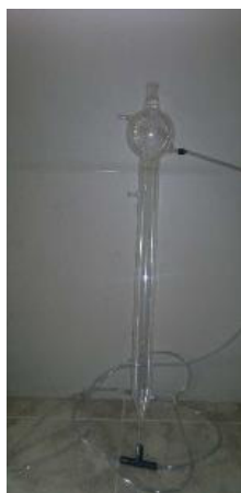
Figura 4.1.- Fotografía del reactor UASB. Fuente: Alcívar 2014
