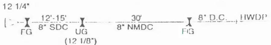
FIG. 1.29 EDF para mantener curvatura con inclinación de 30° y 12 1/4" diámetro.
