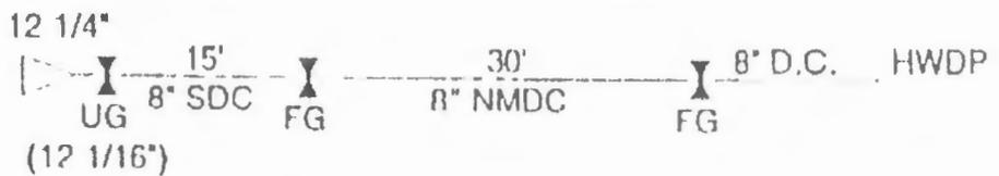
FIG. 1.31 EDF para reducir inclinación lentamente.
