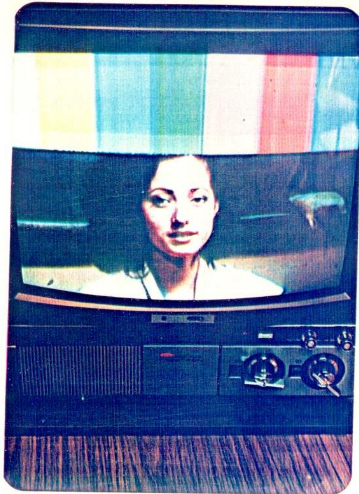
Figura 5.13 EFECTO VERTICAL VISTO EN UN MONITOR A COLOR DEL LABORATORIO DE AYUDAS AUDIOVISUALES DE LA ESPOL.
