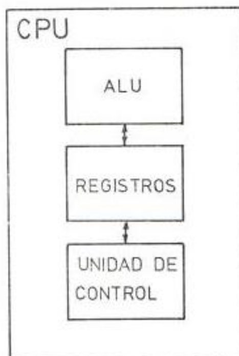
FIG.1.3 UNIDAD DE CONTROL DE PROCESAMIENTO CENTRAL
