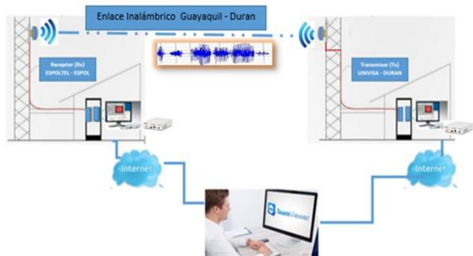
Figura 2.77. Montaje del enlace inalámbrico con equipos NI-USRP 2921 en las casetas de telecomunicaciones [45].
