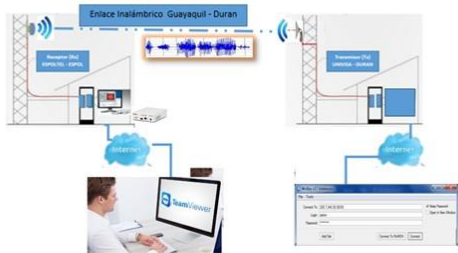
Figura 2.79. Montaje del enlace inalámbrico con equipos NI-USRP 2921 y MikroTik en las casetas de telecomunicaciones [45].
