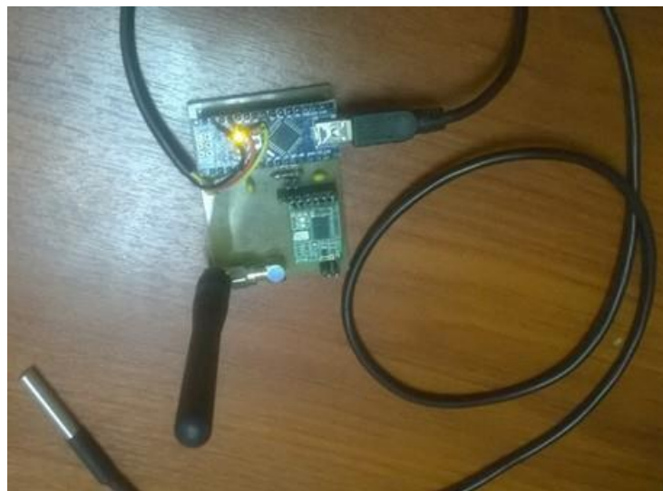
Figura 2.47. Montaje Real del Sensor de temperatura DS18B20 en una placa de arduino
