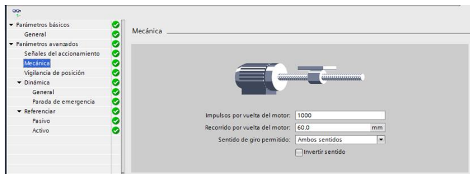
Figura 2.11: Configuración objeto tecnológico EJE: Parámetros avanzados – Mecánica.
