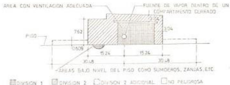
Fig 3-6 - AREA DE PROCESAMIENTO CON VENTILACION INADECUADA
