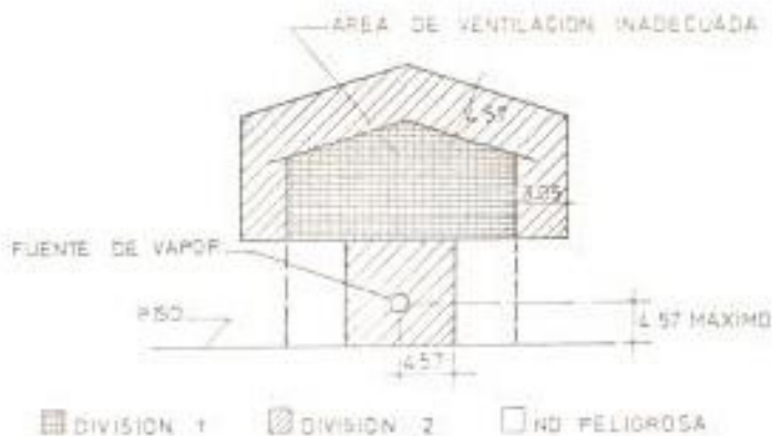
Fig 3-9 - CUARTO DE COMPRESOR CON VENTILACION INADECUADA PARA UN VAPOR MAS LIVIANO QUE EL AIRE.
