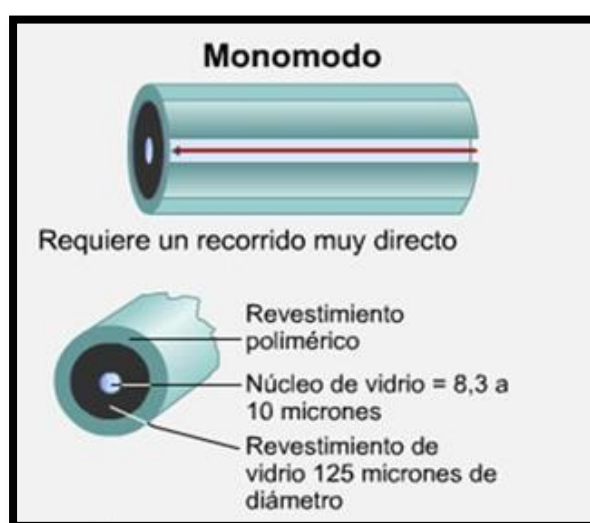
Figura 2.2: Fibra Óptica Monomodo [11].
