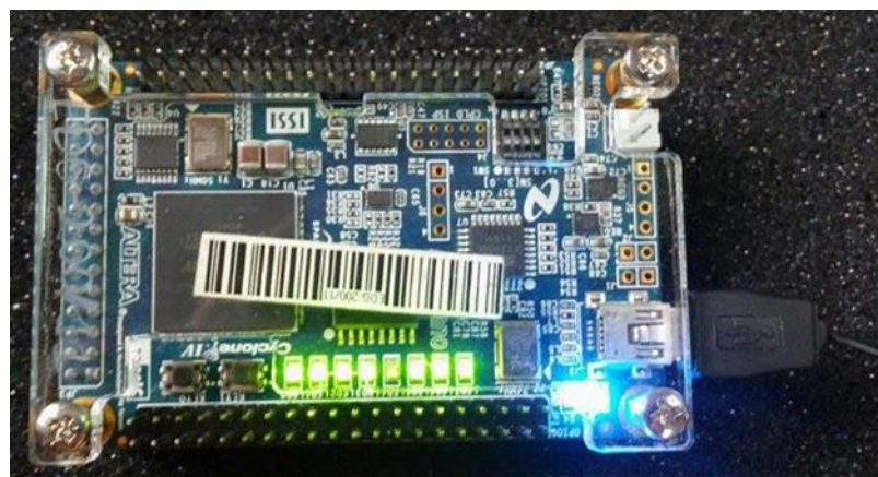
Figura 42. Visualización del contador incremental en los LEDS de la DE0-Nano
