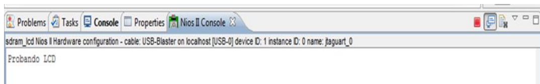
Figura 14. Consola de Nios II SBT, mostrando un mensaje durante la ejecución del código para la escritura en la LCD.
