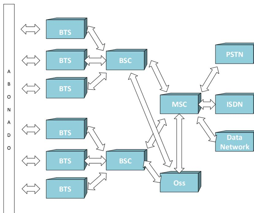
**Figura 2.5: Estructura de red GSM.**
