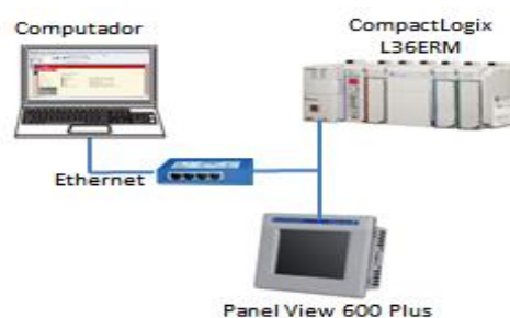
Figura 1: Conexiones de equipos
