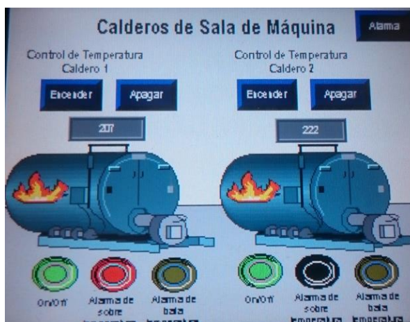
Figura 26: Alarma encendida de temperatura alta del primer caldero
