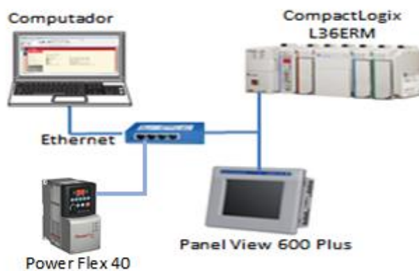
Figura 3.14: Conexiones de la Comunicación del variador Power Flex 40 mediante RSLogix 5000 y Factory Talk View.
