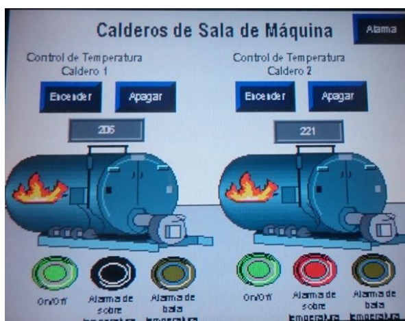
Figura 25: Alarma encendida de temperatura alta del segundo caldero
