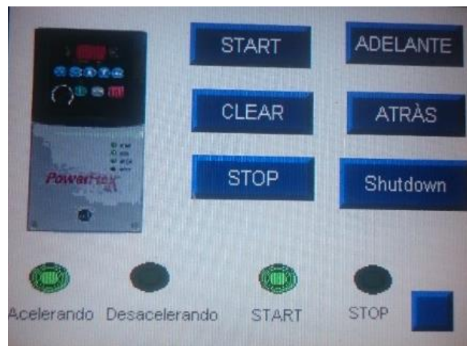
Figura 49: Modo “Accelerating” del variador en el HMI
