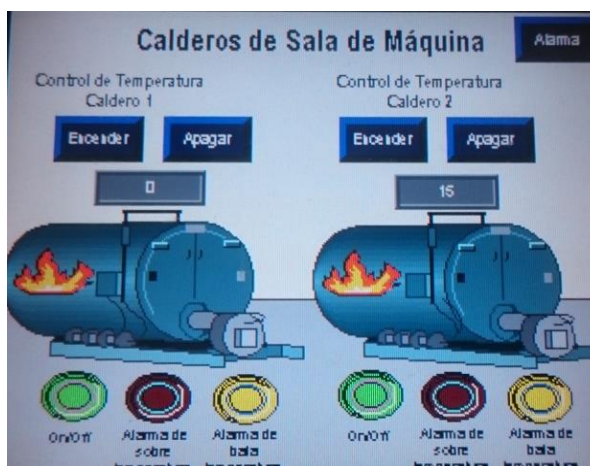
Figura 24: Alarma activada de temperatura baja de ambos calderos
