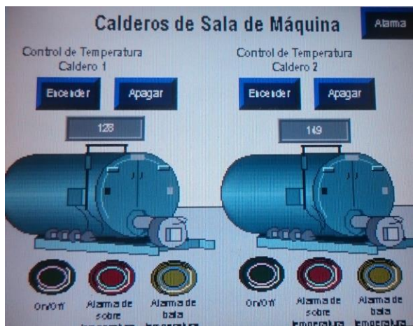
Figura 22 Aplicación de alarmas en el Panel View 600
