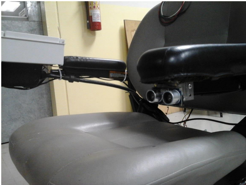
Figura 3.17. Sensor ultrasónico frontal bajo el apoyabrazo izquierdo
