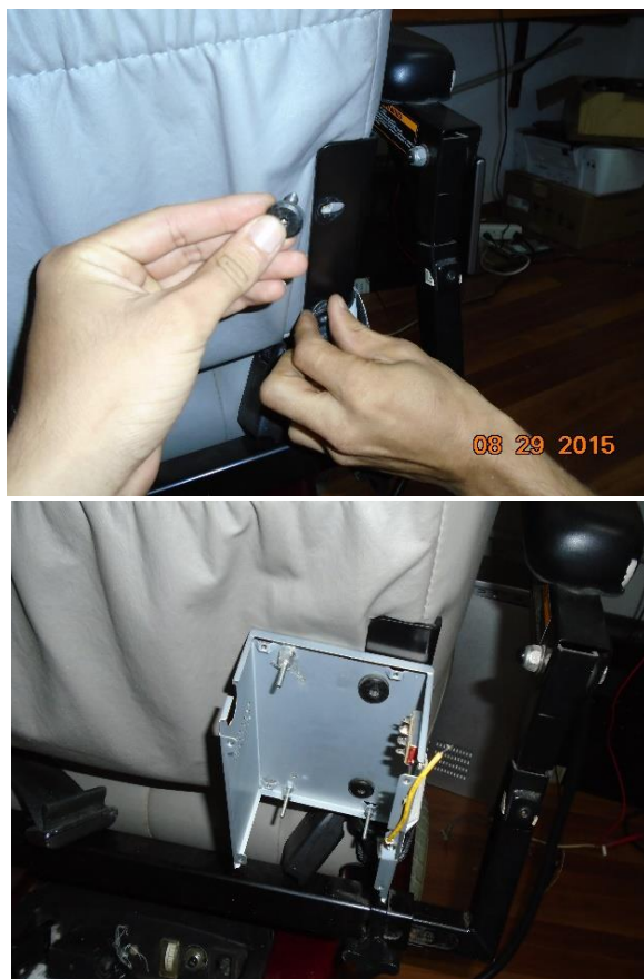
Figura 3.15. Instalación de caja metálica como tierra del circuito
