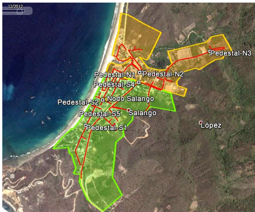
Figura 3.15: Cableado de la Red de Acceso.
