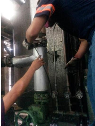
Figura C.1: Usos del Analizador de gases Testo, se está introduciendo la sonda en un orificio de la chimenea.
