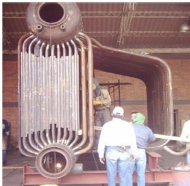
Figura 1.4: Vista Interior de una caldera Acuotubular tipo D.
