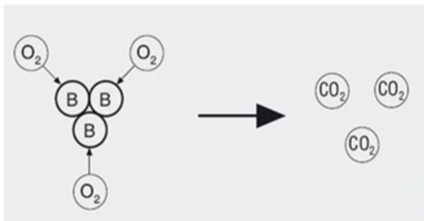
Figura 1.7: Esquema de una combustión ideal.
