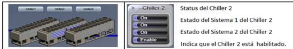
Figura 1. 9 Indicadores del estado de Chiller
