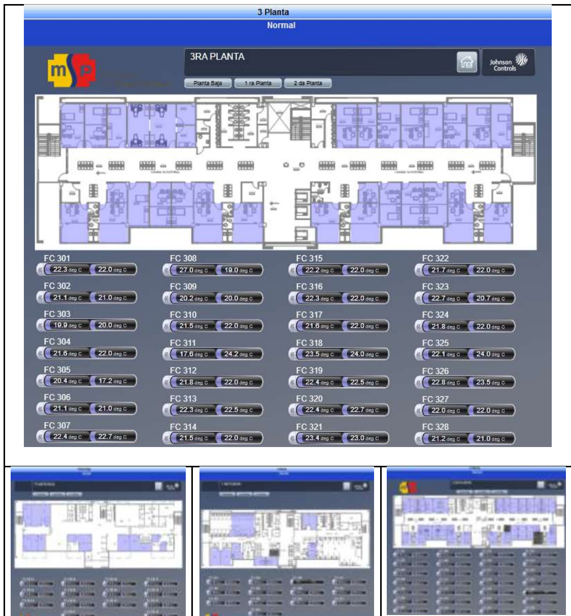
Figura 1. 13 Distribución de FAN COILs en la Torre Hospitalaria
