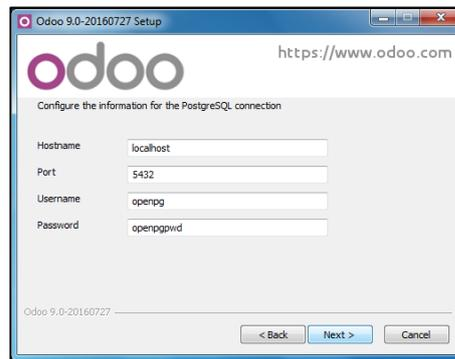
**Figura 5.12: Configuración De Parámetros Para La Conexión Con La Base De Datos**
