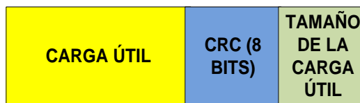
Figura 17. Empaquetamiento de datos a ser transmitidos
