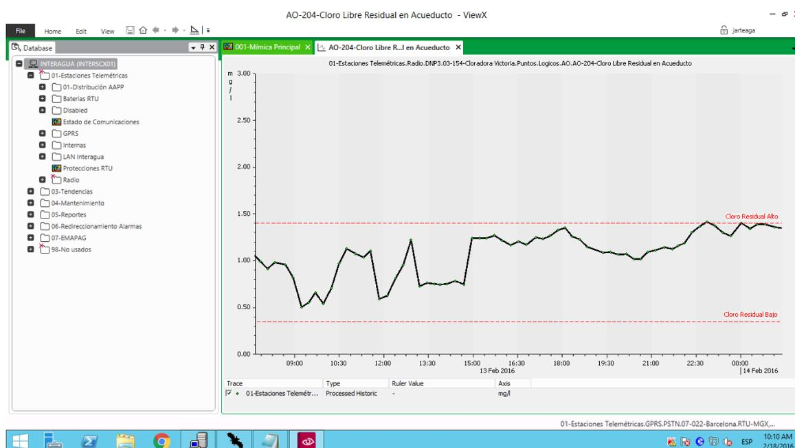
Figura 2.7: Gráfica de tendencia de la variable de cloro residual
