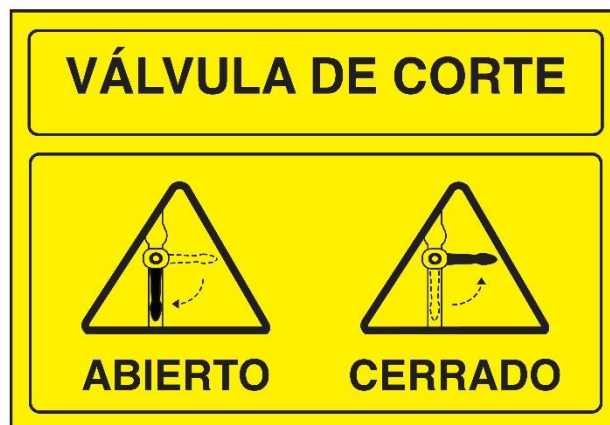
Gráfico 5. 10: Señalización del uso de la válvula de corte de gas
