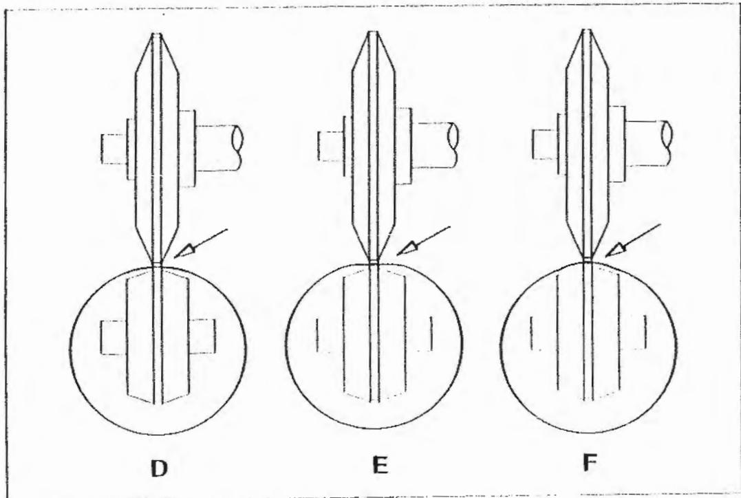
Fig. 249 Altura de la herramienta de calibrado
