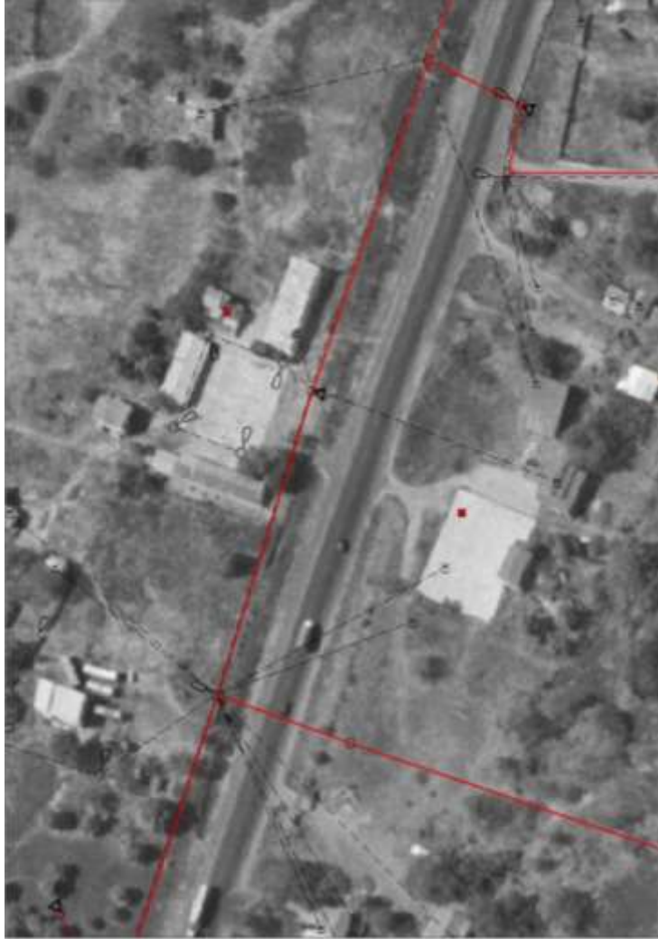
Figura 1.7: Muestra cruce de redes de MT y BT en la vía.
