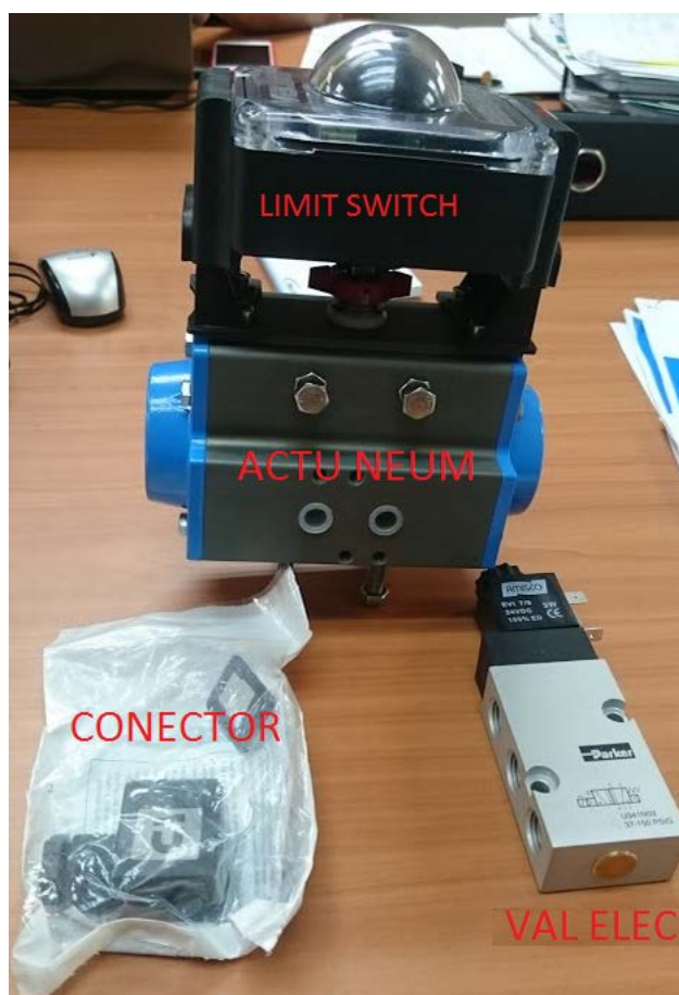
Figura 2.5: Partes de las válvulas instaladas en la línea de molienda.
