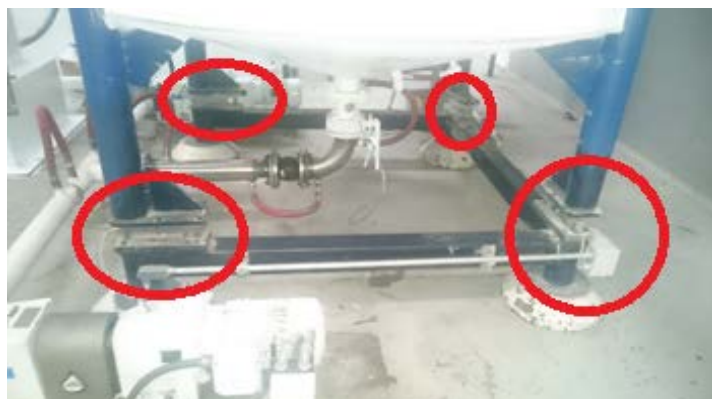
Figura 2.3: Celdas de carga en el tanque de homogenizado de licor de cacao
