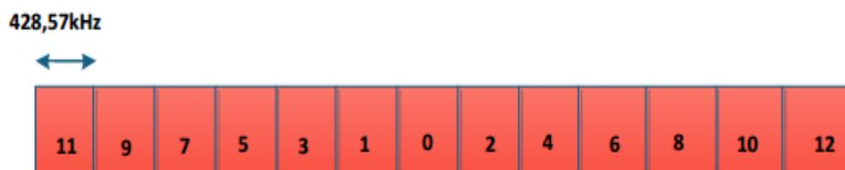
**Figura 2.14: Ancho de banda segmentado [28]**
