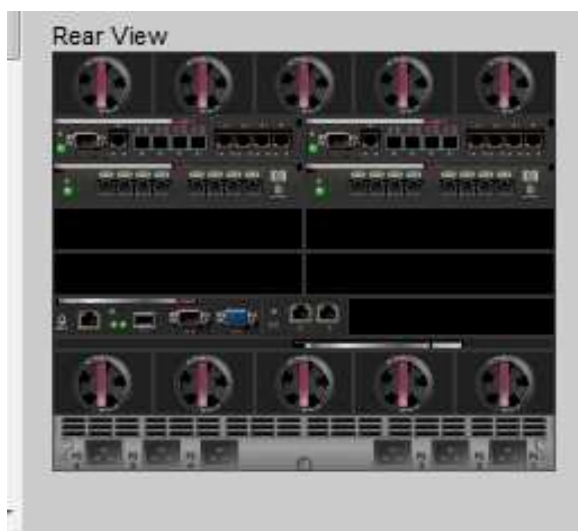
Figura 3.5 Vista posterior de HP BladeSystem Fuentes redundantes
