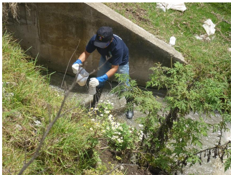
Toma de muestra 1 en canal de descarga, con equipo de protección básico.
