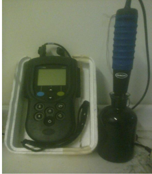
FIGURA 3.3. MEDIDOR DE OXÍGENO DISUELTO PARA ANÁLISIS DE DBO_5
