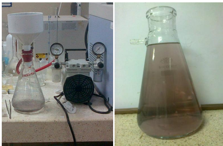
FIGURA 4.4. FILTRACIÓN AL VACÍO DEL EFLUENTE CON pH AJUSTADO A 3 (IZQUIERDA) Y MUESTRA FILTRADA (DERECHA)
