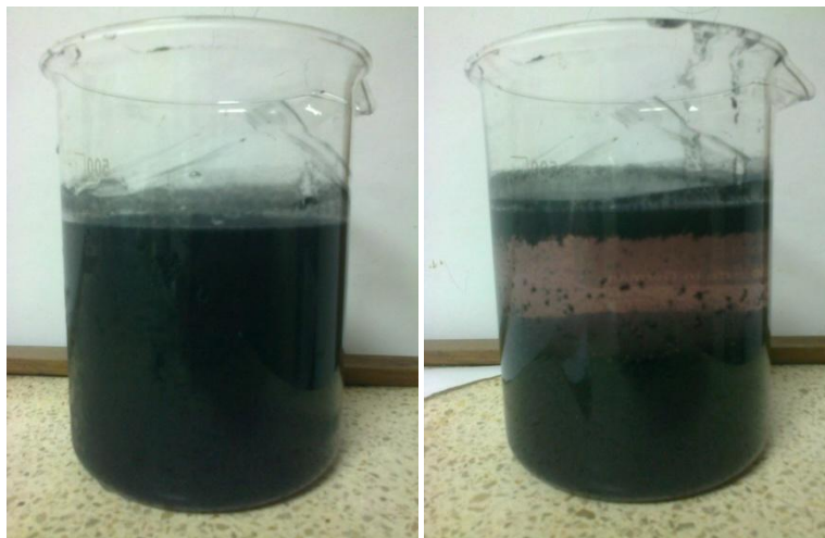
FIGURA 4.3. MUESTRA CRUDA (IZQUIERDA) Y MUESTRA A pH 3 LUEGO DE 30 MINUTOS DE ACIDIFICACIÓN (DERECHA)
