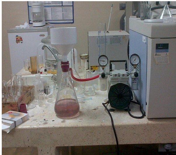
FIGURA 3.7. SISTEMA DE FILTRACIÓN AL VACÍO PARA REMOCIÓN DE SÓLIDOS SEDIMENTABLES DEL EFLUENTE A PH 3
