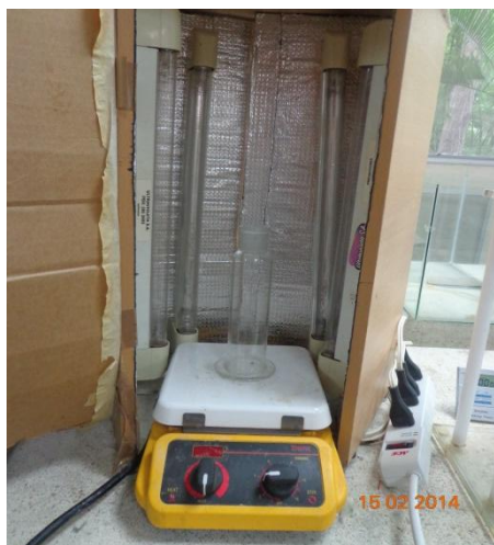
FIGURA 3.8. SISTEMA CON LAMPARAS UV ( \lambda=254 NM) EMPLEADAS EN EL PROCESO DE FOTO-FENTON
