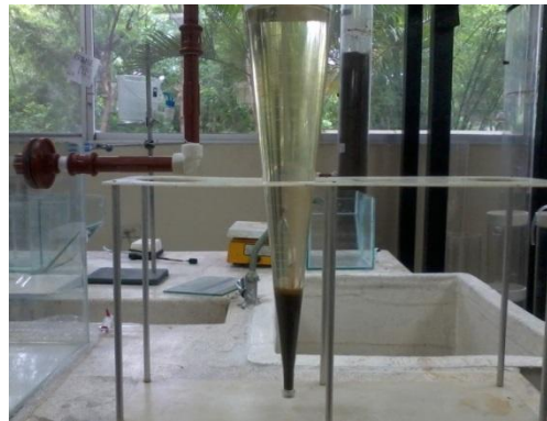
FIGURA 4.7A. CONO IMHOFF PARA DETERMINACIÓN DE LODOS GENERADOS LUEGO DE NEUTRALIZACIÓN EN EL PROCESO DE FENTON.
