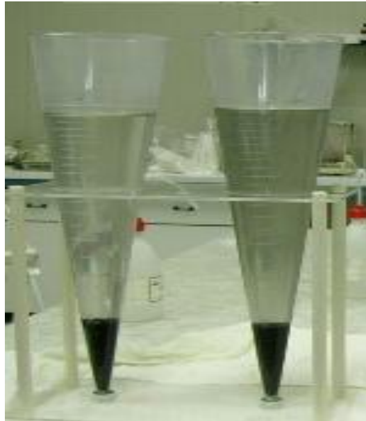
FIGURA 3.4. CONOS IMHOFF PARA MEDICIÓN DE SÓLIDOS SEDIMENTABLES
