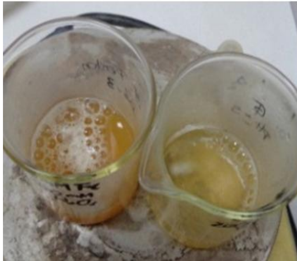
FIGURA 4.11. ASPECTO DE LAS MUESTRAS LUEGO DE 5 MINUTOS DE REACCIÓN APLICANDO 200 mM H 2 O 2 Y 3 mM FeSO 4 (IZQUIERDA) Y APLICANDO 200 mM H 2 O 2 Y 0.6 mM FeSO 4 (DERECHA); PH 3, T=25°C
