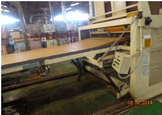
FIGURA 2.6. PROCESO DE IMPRESIÓN, RANURA Y TROQUELADO DE LÁMINAS DE CARTÓN CORRUGADO
