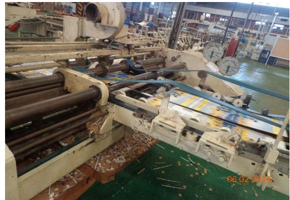
FIGURA 2.6. PROCESO DE IMPRESIÓN, RANURA Y TROQUELADO DE LÁMINAS DE CARTÓN CORRUGADO
