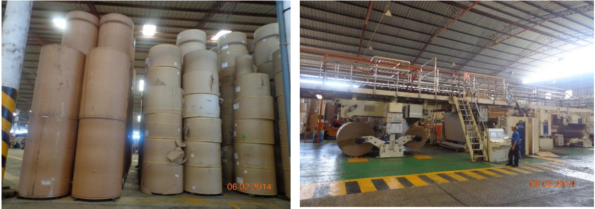
FIGURA 2.3. BOBINAS DE PAPEL KRAFT Y LINER A SER ALIMENTADAS EN LA MÁQUINA CORRUGADORA
