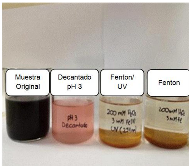
FIGURA 4.16. ASPECTO DE MUESTRAS DECANTADAS A PH 3, Y POSTERIORMENTE TRATADAS CON LOS TRATAMIENTOS DE FENTON Y FOTO-FENTON APLICANDO 200 mM H 2 O 2 Y 3 mM FeSO 4 .
