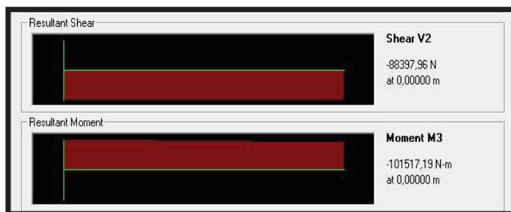
Figura C – 3 - Valores de cortante y momento para la viga 3 Fuente: Análisis en SAP2000 V16. Willy Morales – 2017. Elaboración Propia
