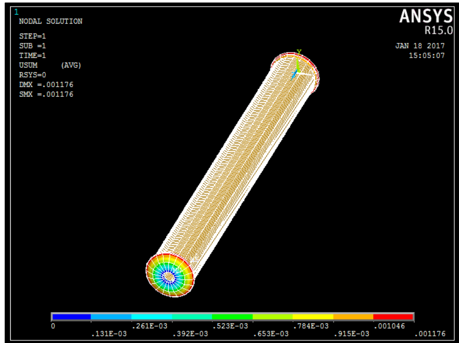
Figura 2.31 Deformación de la Tubería
