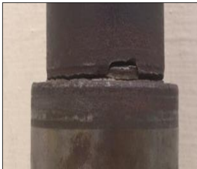
Figura 2.36 Vista Frontal de la Fractura del Eje
