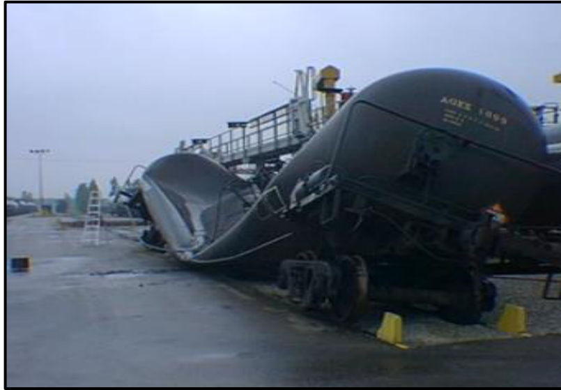
Figura 1.4 Falla de tanque por presión de vacío
