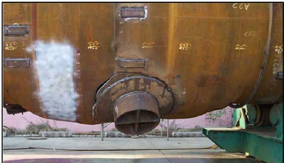
Figura 1.2 Daño por sobrepresión durante prueba hidrostática
