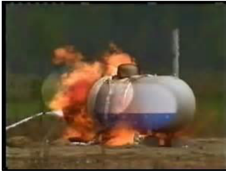
Figura 1.5 Tanque previo a BLEVE
