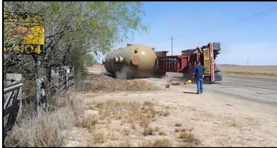
Figura 1.6 Daño en tanque por vuelco de transporte
