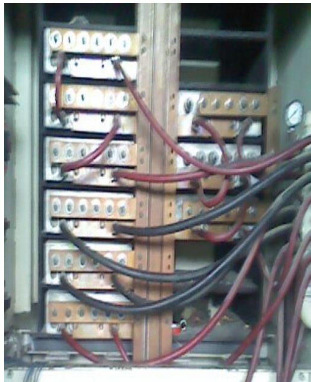
Figura 1.5: Foto del banco de capacitores de salida para la selección de frecuencia de operación
