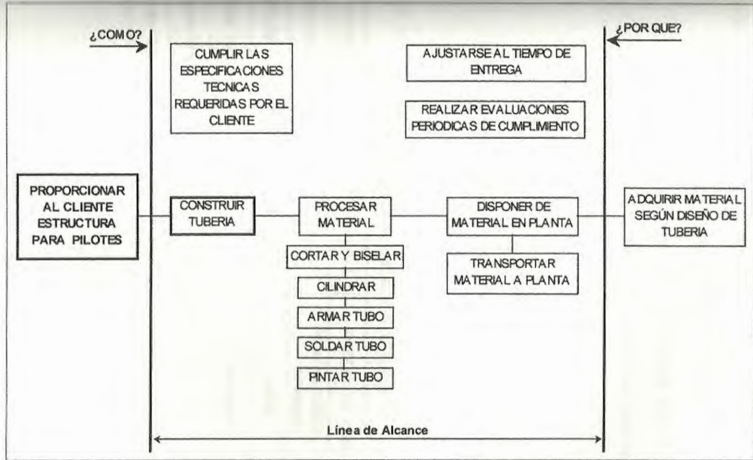
Figura 3.6 Diagrama Fast - Construcción de Tuberías
