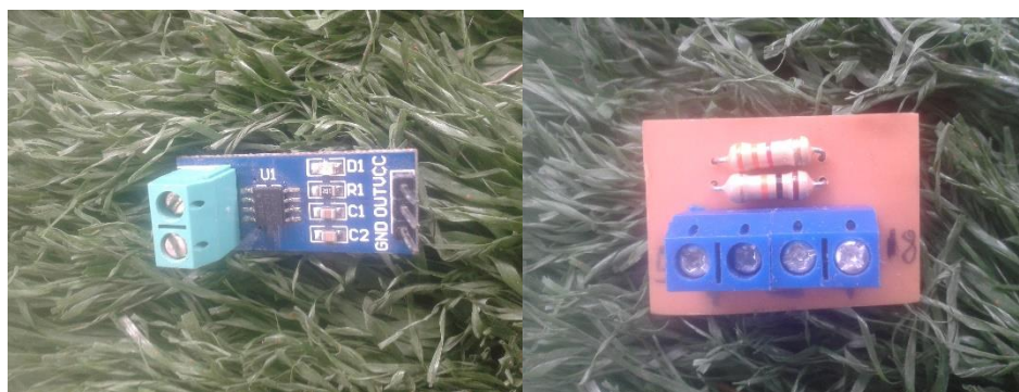
Figura 3.15: Módulos para Medición de Potencia.
