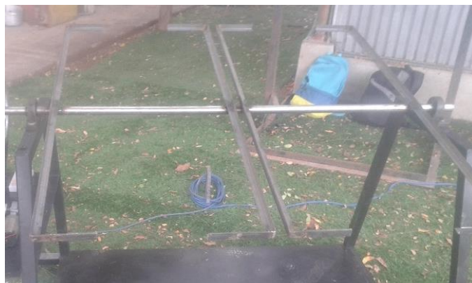
Figura 3.10: Soporte de los Paneles Fotovoltaicos.
