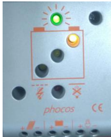
Figura 3.20: Controlador de Carga Solar.
