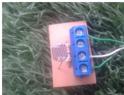
Figura 3.12: Módulo para Medición de Luz.
