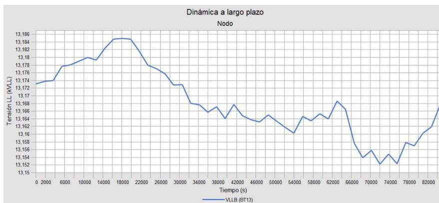
Figura 3.11: Análisis dinámico a largo plazo Voltaje VLLB en BT13.
