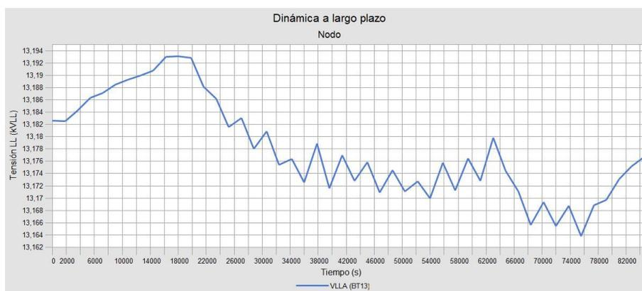
Figura 3.10: Análisis dinámico a largo plazo Voltaje VLLA en BT13.
