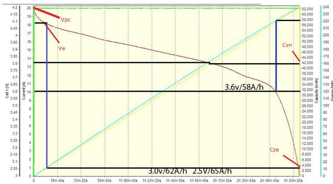
**Figura B.1: Característica de descarga de una celda del paquete de batería de Nissan Leaf.**
