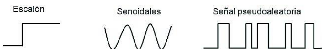
FIGURA 2.15. Señales más utilizadas para identificación de sistemas.[16]
