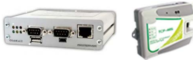
FIGURA 2.4 Central datalogger autónoma.
