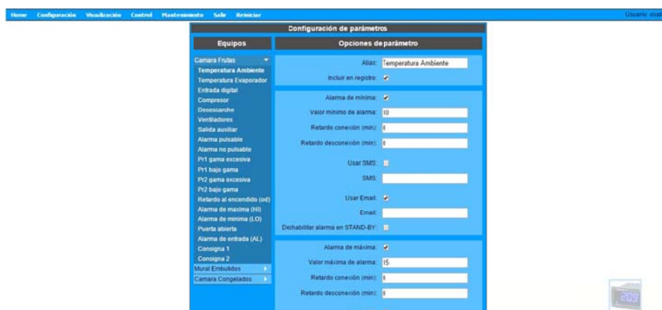
Figura 2.9 Configuración de componentes de Refrigeración Industrial
