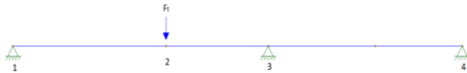
Figura 3.7. Esquema del eje del generador.
