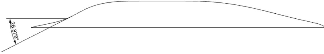
**Figura No. D. 5** Verificación de ángulo de salida en la manzana de la helice.
