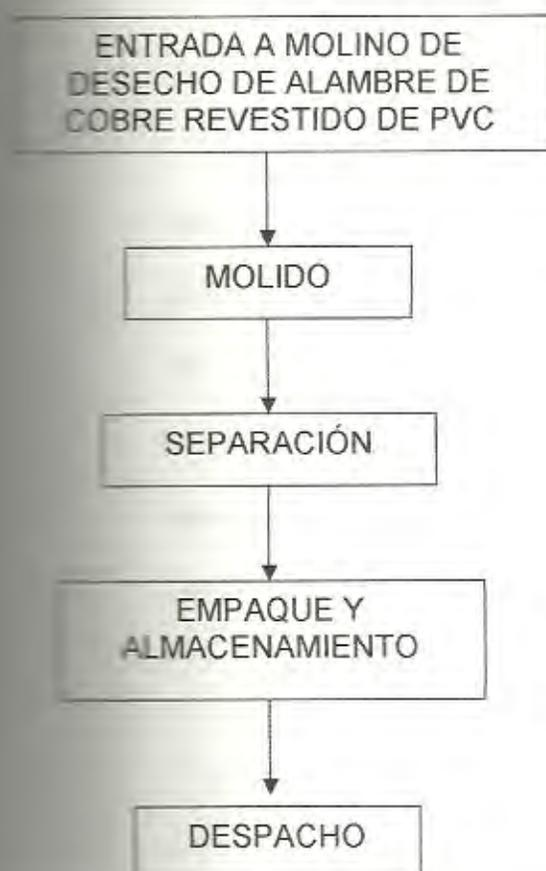
FIGURA 1.7 Diagrama de flujo del proceso de eliminación de chatarra de alambre de cobre revestido de PVC
