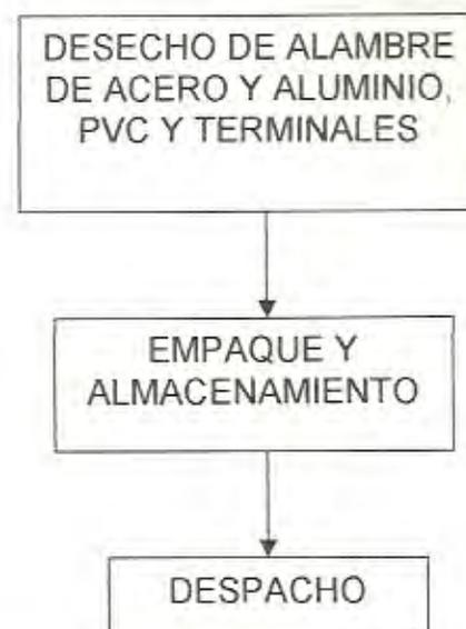
FIGURA 1.8: Diagrama de flujo del proceso de eliminación de chatarra de Al, acero, PVC y terminales
