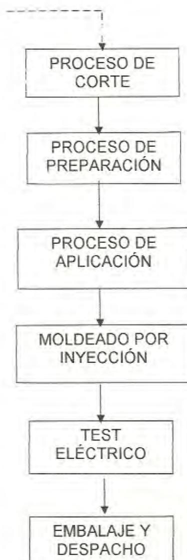
**FIGURA 1.5:** Diagrama de Flujo del Proceso de producción de enchufes y extensiones eléctricas
