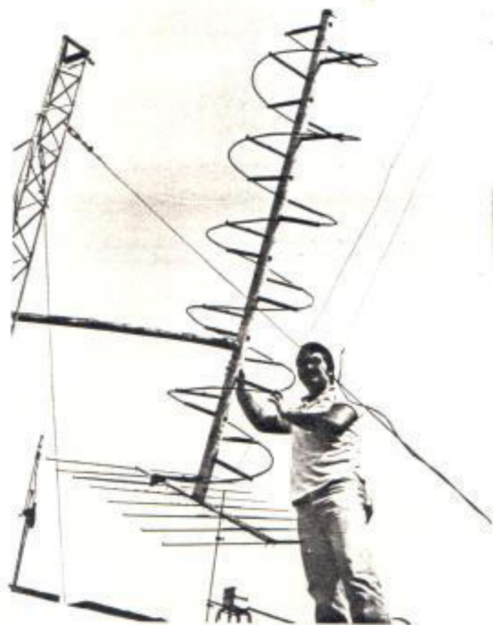
FOTO 4 El Sr. Jaime Alfaro, HC2CEV, junto a la antena helicoidal para 2 m implementada para la estación terrena de su propiedad.
