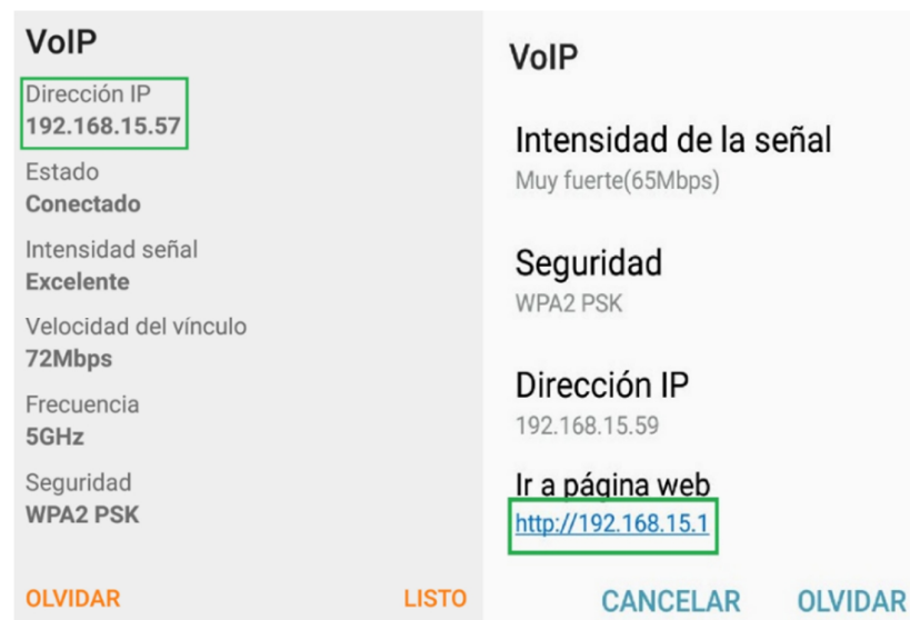
Figura 3.83. Configuración automática de red inalámbrica en un celular conectado a la red VoIP.
