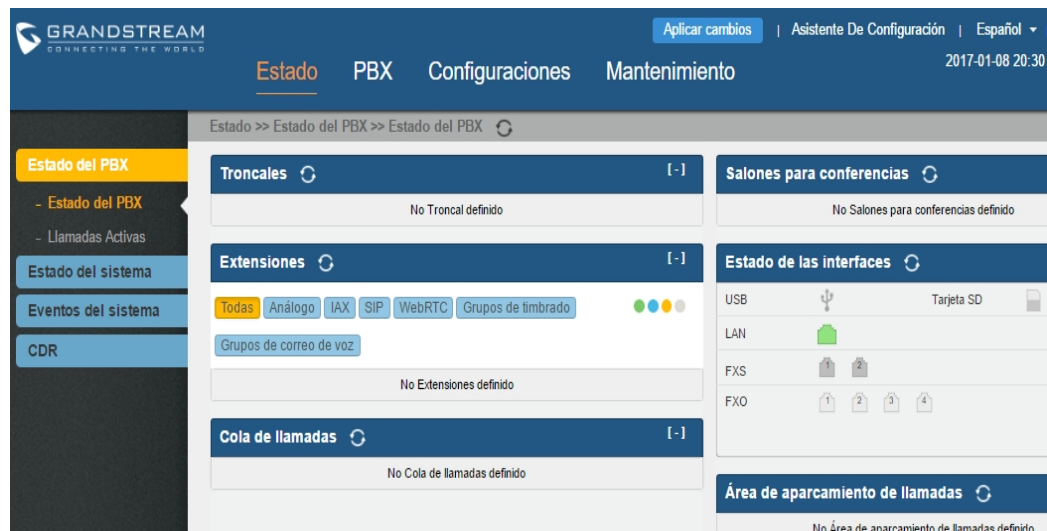
Figura 3.47. Pantalla inicial de estado en web de administración de la central telefónica.
