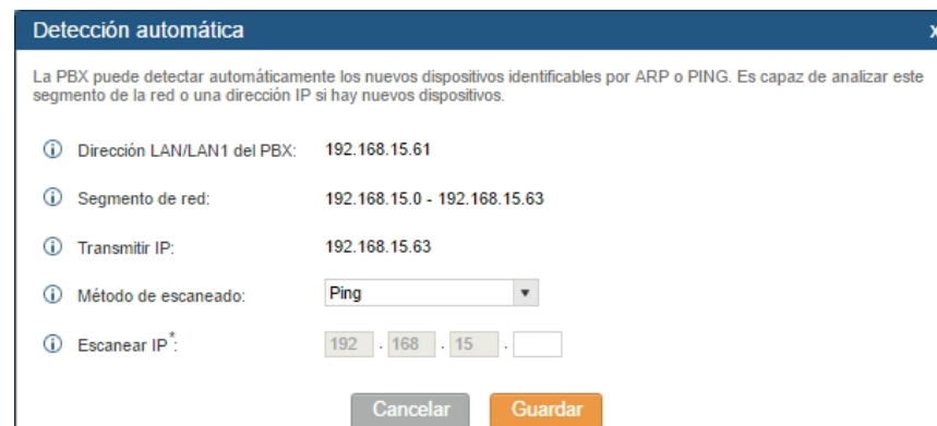
Figura 3.66. Ventana emergente que permite la búsqueda de un teléfono, mediante procedimientos ARP o PING permitirá escanear teléfonos en la red.
