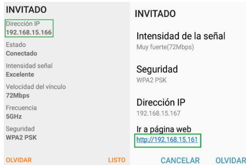
Figura 3.84. Configuración automática de red inalámbrica en un celular conectado a la red INVITADO.
