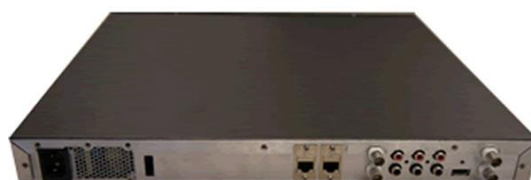
Figura 2.17: Procesador de Video IMX e4100, vista posterior
