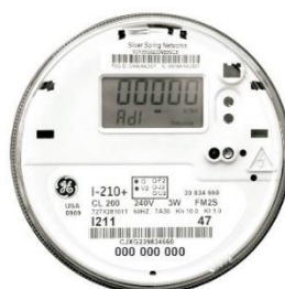
Figura 3.6 Smart Meter con tecnología AMI [42]
