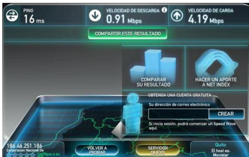
**Figura 4.19:** Velocidad después del QoS a 1Mbps
