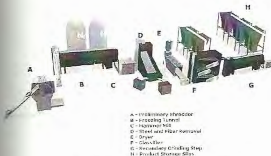
Fig. 2.9 Molido criogénico de neumáticos usados
