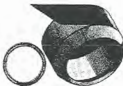
Fig. 1.7 Montaje de capa radial, laterales, telas y pestañas de un neumático
