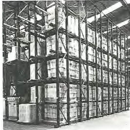
FIGURA 2.6 ESTANTERÍA PARA ALMACENAMIENTO DE PALLETS EN PROFUNDIDAD (DRIVE IN)
