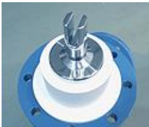
**Figura 2.8 Sensor LiquiSonic® incorporado en la válvula de salida inferior del reactor.**
