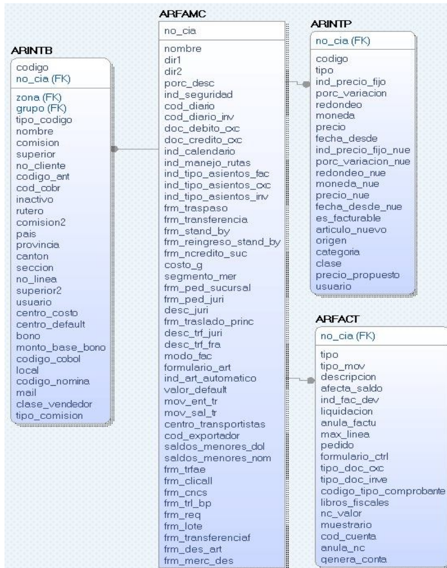
Figura 3.2. Diagrama E-R del proceso de facturación
