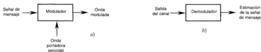
Figura 2. 20: Componentes de un sistema de modulación de onda continua: a) transmisor y b) receptor [17]
