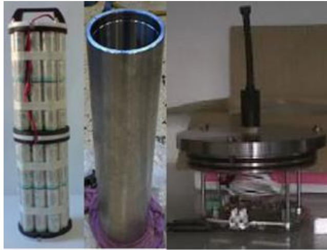
Figura 3. 19: Estructura contenedora de la Batería. [27]
