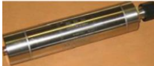
Figura 3. 16: Sensor de presión Digiquartz Paroscientific. [27]
